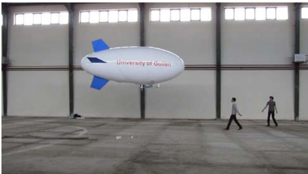
شکل ۳: کشتی هوایی دانشگاه گیلان در حال تست Indoor
