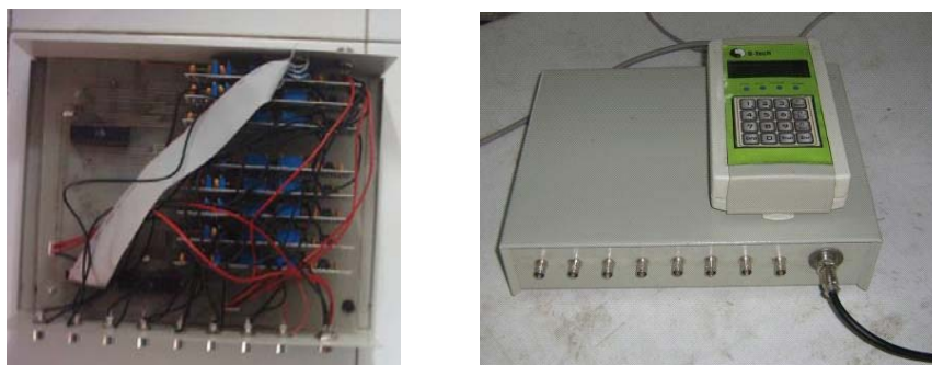
شکل (الف): نمای خارجی دستگاه ثبت شتاب شکل (ب): مدار کامل مونتاژ شده در جعبه شکل (۲): دستگاه ثبت شتاب.
